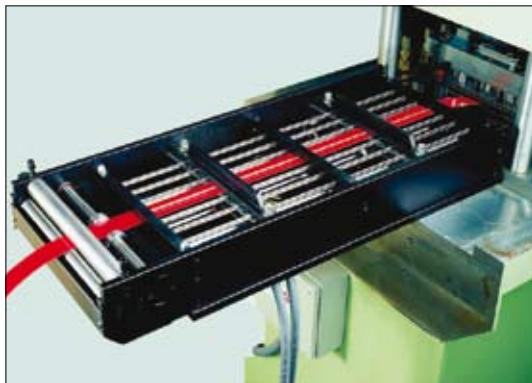
Fig. 21 - Alimentatore elettronico a pinza bialternato a vite e madrevite.
