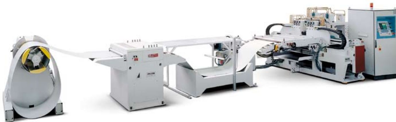
Fig. 4 Ligne de poinçonnage de bobine avec dérouleur, redresseur et poinçonneuse de bobine.
