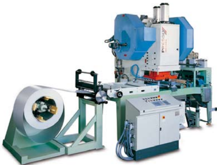
Fig. 5 Ligne d'emboutissage avec presse.
